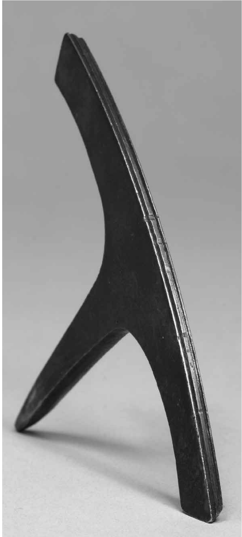
Abb 2: Filete zur Herstellung von Doppellinien; Messing, 19. Jh.; Inv.-Nr. Z 2643_16.
